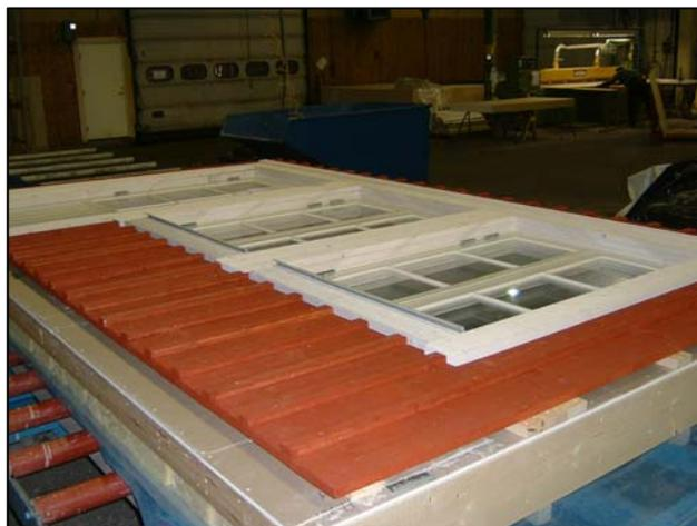
Fig. 2.3.3.1 – Particolare di un pannello pronto in fabbrica
